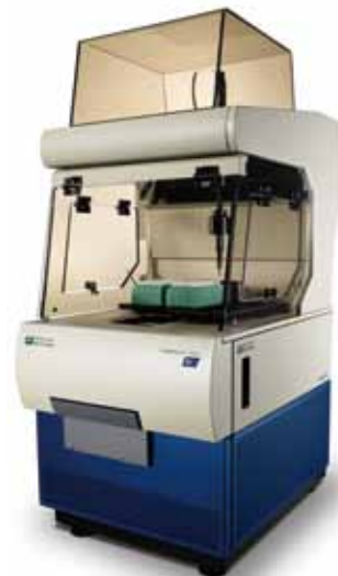
ImageXpress Micro XLS配置 已安装移液装置及环境控制部件
