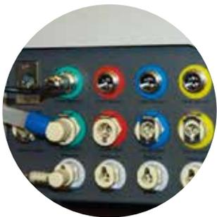
图 2. 不同颜色标记的接口。不同颜色标记的接口可以减少组装时间，不用更换洗液瓶就可以应用多个缓冲液和试剂。液面传感器和容器传感器连接即可检测容器内液体的体积。
