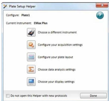
实验设置模块可指导用户一步一步的设置实验。软件会自动识别并连接仪器。然后软件会针对特定的读板机应用预设并建立模板。针对本次设置，EMax Plus已被默认选择。
