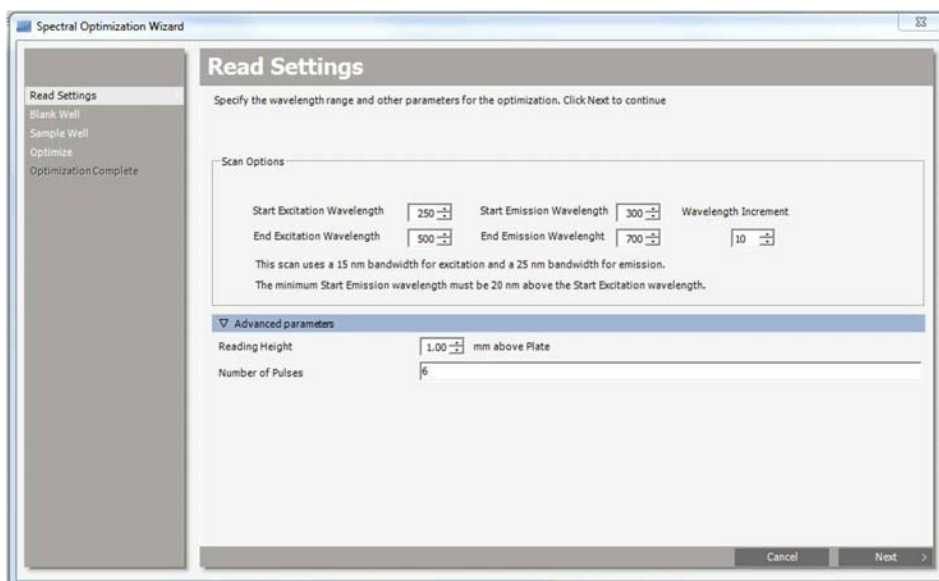
图二: 纳米颗粒光谱扫描参数。图中展示了针对氧化铁和氧化锌纳米颗粒(包被样本和对照样本)的光谱扫描参数。对于氧化锌纳米颗粒样本, 波长步进为5 nm。
