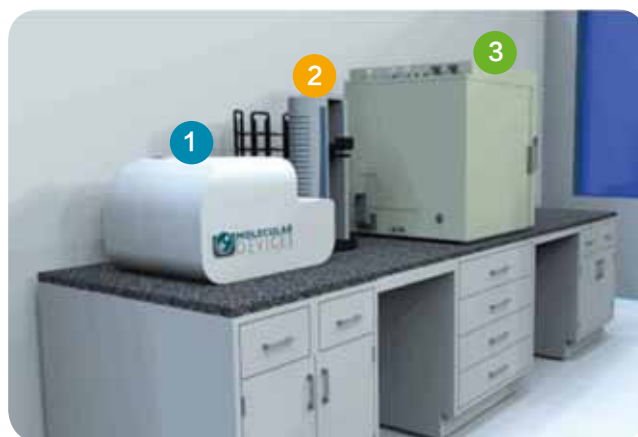
图2：典型的仪器构成用于实现孔板在细胞克隆成像仪与培养箱之间转移。 1. CloneSelect Imager 2. 机械臂 3. 培养箱
