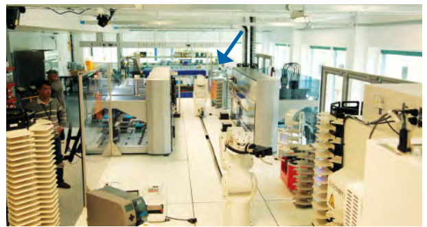
개조된 QPix system (파란 화살표) 부터 plate hotel 까지 접근 가능한 robotic arm
