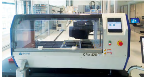
Robotic arm의 접근이 가능하도록 Qpix후면 개조
